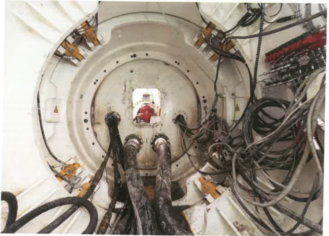
Figure 6 : Détail du module articulé / Steering joint detail
